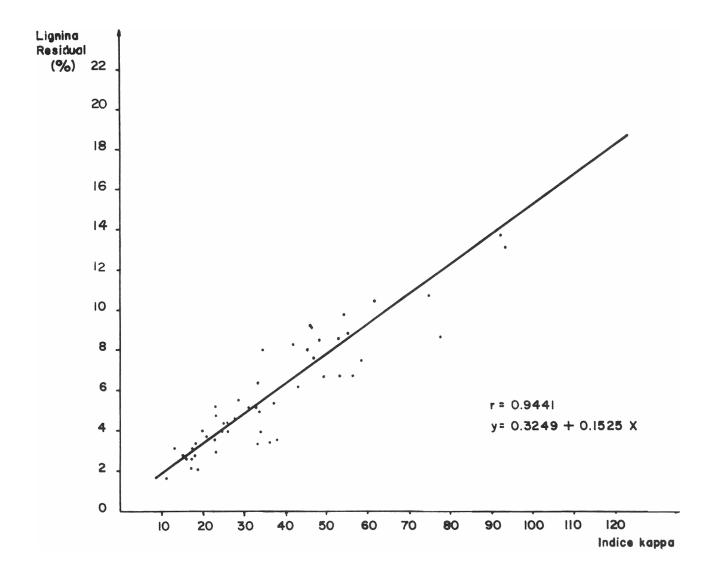
Fig. 2.- Correlación entre índice kappa y lignina residual en pulpa química al sulfato
