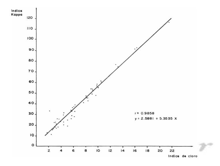
Fig. 3.- Correlación entre índice de cloro e índice kappa en pulpa química al sulfato
