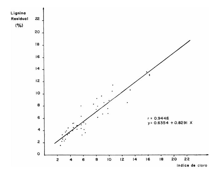
Fig.1.- Correlación entre índice de cloro y lignina residual en pulpa química al sulfato
